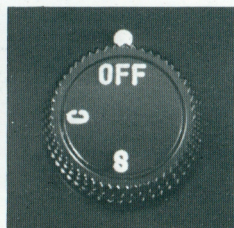
電源回路切れる Cut off the Circuit
