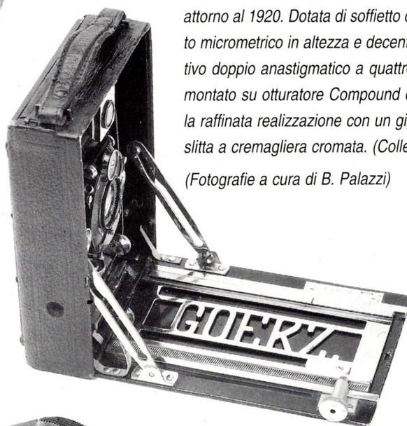
Questa Goerz Tenax a lastre è una bella 9x12cm prodotta probabilmente attorno al 1920. Dotata di soffietto con doppio allungamento, decentramento micrometrico in altezza e decentramento laterale libero, monta un obiettivo doppio anastigmatico a quattro lenti indipendenti Syntor 130mm f/6,8 montato su otturatore Compound con tempi da 1/20 a 1 s. Degna di nota la raffinata realizzazione con un gigantesco marchio Goerz intagliato nella slitta a cremagliera cromata. (Collezione privata).
