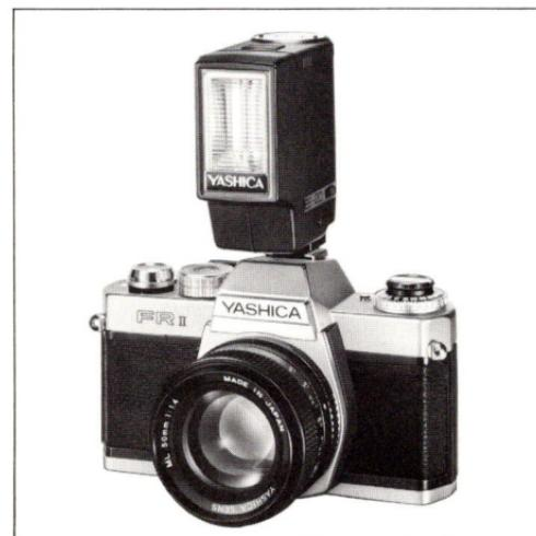
**③** Stellen Sie scharf ein und lesen Sie dann den Abstand zwischen Kamera und Motiv ab, der auf der Entfernungsskala des Objektivs angezeigt wird. Der der Motiventfernung entsprechende richtige Blendewert kann durch Dividieren der Blitzgerät-Leitzahl durch jene Entfernung berechnet werden. Bei einer Entfernung von 5 Metern und einer Leitzahl von 20 (ASA 100 in Metern) beträgt der richtige Blendewert zum Beispiel 1:4: Leitzahl 20 ÷ 5 (Entfernung in Metern) = 1:4.
