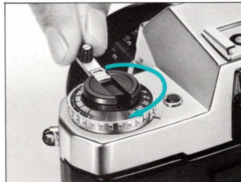
**4** Bewegen Sie den Filmtransporthebel mit Ihrem Daumen über die Kante der Kamera und transportieren Sie den Film etwas, bis die Zähne der Filmtransportrolle einwandfrei in die Randlochungen des Filmes eingreifen. Schließen Sie die Kamerarückwand und drücken Sie diese nieder, bis sie einrastet.
