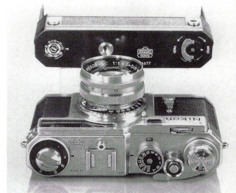
Una Nikon SP, cromata, con Nikkor S-C 5cm f/1.4 e motore con portabatterie.
