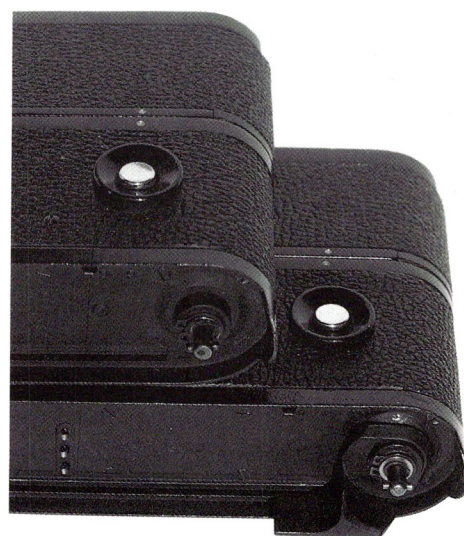
Particolare del Leicamotor terzo tipo (in secondo piano) e del Leicamotor del secondo tipo (in primo piano). Si osserva il dispositivo, in plastica, per la guida della pellicola.
