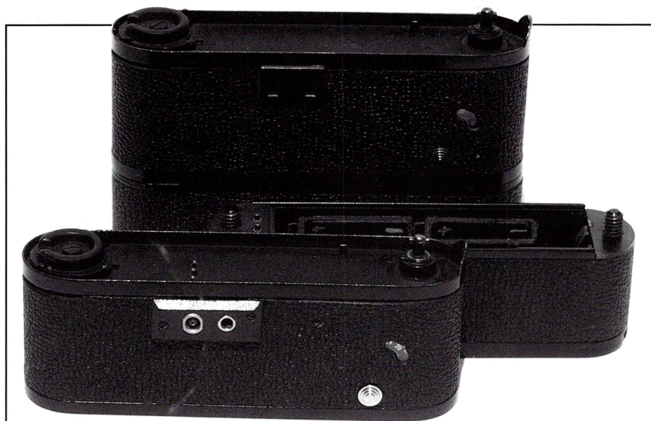
Leicamotor del primo tipo (in secondo piano) e Leicamotor del secondo tipo (in primo piano), vista posteriore. Fra i due è posto un portabatterie. Si osservano il conta-fotogrammi, con il relativo pulsante di controllo, e le prese per il comando a distanza e l'alimentazione esterna.
