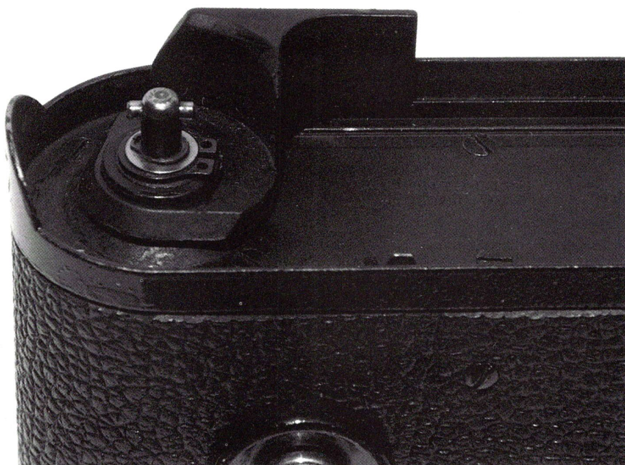
Particolare del dispositivo, in plastica, per la guida della pellicola, presente nel terzo tipo del Leicamotor.
