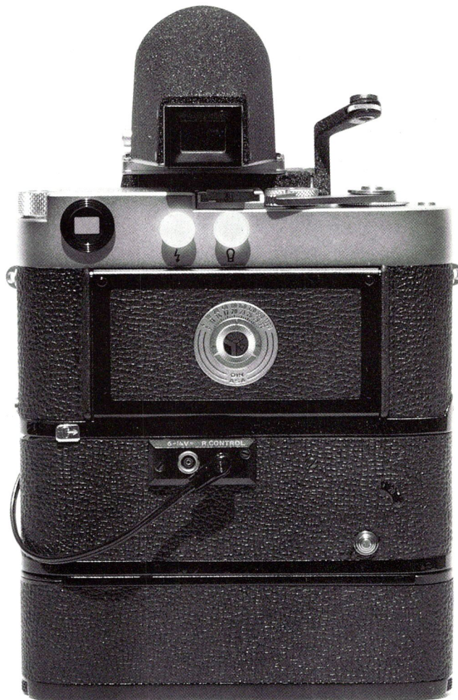
A sinistra, il complesso formato da una Leica M2-M (n. 1.164.037), da un Leicamotor del secondo tipo (n. 02349) e da un Visoflex III con comando elettrico per l'uso con il Leicamotor (veduta anteriore). A destra, complesso formato da una Leica M2-M (n. 1.164.037), da un Leicamotor del secondo tipo (n. 02349) e da un Visoflex III con comando elettrico per l'uso con il Leicamotor (veduta posteriore).
