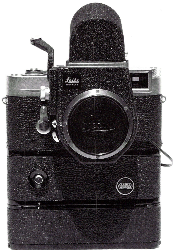
A sinistra, il complesso formato da una Leica M2-M (n. 1.164.037), da un Leicamotor del secondo tipo (n. 02349) e da un Visoflex III con comando elettrico per l'uso con il Leicamotor (veduta anteriore). A destra, complesso formato da una Leica M2-M (n. 1.164.037), da un Leicamotor del secondo tipo (n. 02349) e da un Visoflex III con comando elettrico per l'uso con il Leicamotor (veduta posteriore).
