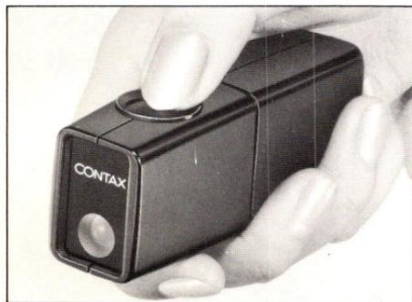
Es ist eine Anzahl von Leeraufnahmen zu machen, bevor Sie den Film laden, um festzustellen, ob das Infrarot-Steuergerät richtig arbeitet.
