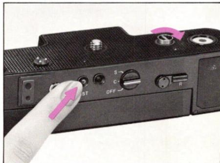
■ Beim Überprüfen der Winder-Funktion nach Zurückspulen des Filmes stellen Sie die Wahlscheibe auf "C" oder "S" und drücken die Prüftaste. Summen des Motors und sofortiges Aufleuchten der Filmendanzeige nach Loslassen der Taste sind eine Anzeige dafür, daß der Real Time Winder einwandfrei funktioniert (oder daß die Batteriespannung ausreichend ist).
