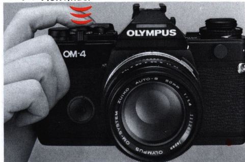
2. Auslöser leicht andrücken: Die Informations- anzeige im Sucher wird eingeschaltet. Appuyer doucement sur le bouton de déclen- chement. Oprima ligeramente el disparador para activar la información del visor.
