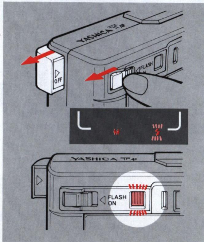
*Bei Innenaufnahmen und Nachtaufnahmen drücken Sie den Auslöser etwas nach unten. Wenn das Blitzsignal im Sucher aufleuchtet, benutzen Sie den eingebauten Blitz, um helle klare Bilder zu erhalten.*
