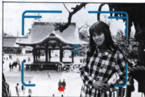
*Falls sich das Motiv, das fokussiert werden soll, wie in dieser Abbildung gezeigt, nicht in der Mitte der Aufnahme befindet, oder beim Fotografieren eines Motivs, bei dem die Auto-Fokus-Einrichtung wie unten beschrieben keine einwandfreie Scharfeinstellung ermöglicht, empfiehlt sich der Gebrauch der Fokussierverriegelung.*
