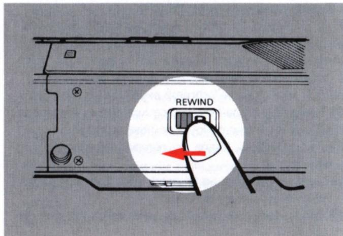
*Spulen Sie den Film unbedingt immer zurück, wenn das Filmende erreicht ist. Da sich jetzt Filmtransport und Auslöser nicht mehr bedienen lassen, schalten Sie den Filmrückspulschalter ein. Der Film wird daraufhin automatisch zurückgespult.*
