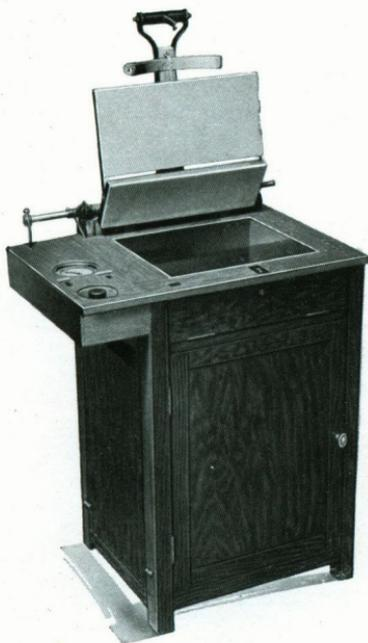
La graduation du compte-pose et du rhéostat permettent en les notant de reprendre le même cliché ultérieurement et de poser exactement pour un nouveau tirage.
