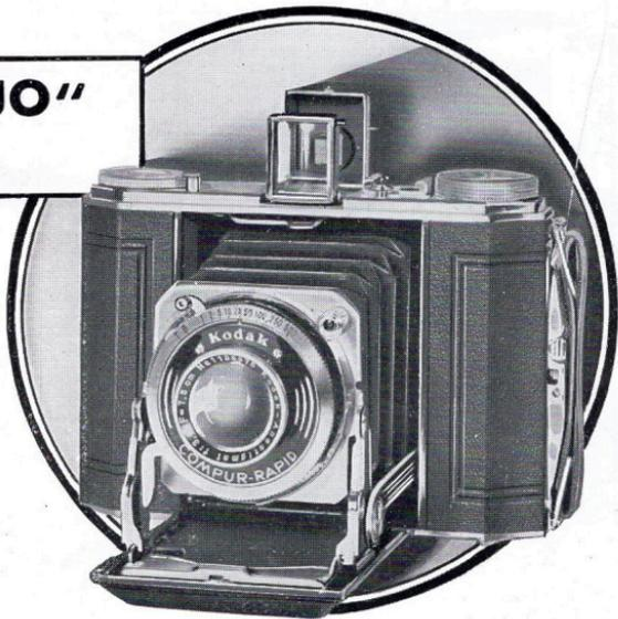
C'EST un appareil qui fera la joie des amateurs de petits formats. Il utilise des bobines  $6 \times 9$  cm. de 8 poses, mais donne 16 images directes de  $4,5 \times 6$  cm., chaque cliché fournissant deux vues. A cet effet, le dos de l'appareil est pourvu de deux fenêtres rouges, au centre desquelles les différents numéros s'arrêtent alternativement.
