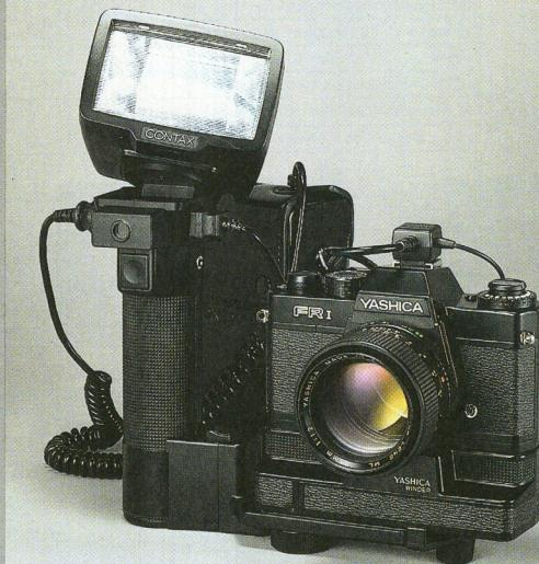
*Flash electrónico RTF 540 con disparador electromagnético integral. Sincroniza con las velocidades de obturación del bobinador y del regulador de intervalos; ofrece destellos múltiples estroboscópicos de hasta 5 disparos por seg.*
