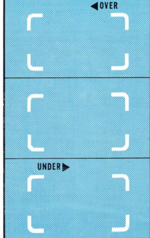
3. Blendenring drehen, während der Batterieknopf gedrückt wird. Schauen Sie durch den Sucher und drehen Sie den Blendenring. Die Warnlampen „OVER“ oder „UNDER“ leuchten jetzt auf. Die richtige Belichtung ergibt sich in der Blendenstellung, in der keines der beiden Warnsignale mehr aufleuchtet.
