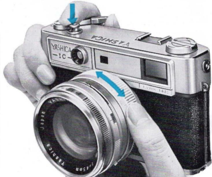
3. Bei gedrücktem Einschalter blicke man durch den Sucher und drehen den Blenderring, bis die beiden rote Warnzeichen „OVER“ und „UNDER“ erloschen.
