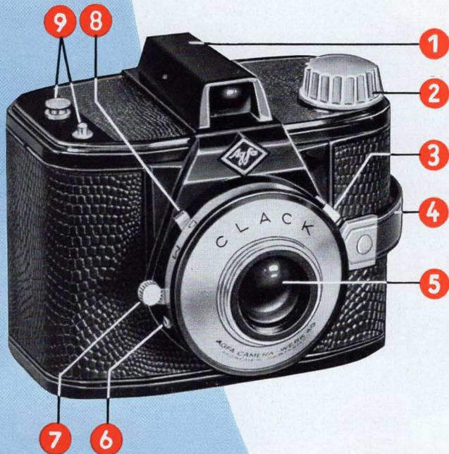
Um die optische Leistung der eingebauten Meniskuslinse voll auszuwerten, ist die Filmebene gewölbt. Deshalb ist die Agfa Clack so handlich. Von 3 m bis „unendlich“ zeichnet die Agfa Meniskuslinse scharf. Ein weiterer Vorzug ist die eingebaute Vorsatzlinse für Nahaufnahmen von 1 m bis 3 m. Für Aufnahmen im Heim und bei schlechten Lichtverhältnissen wurde der Agfa Clack-Blitzer geschaffen.
