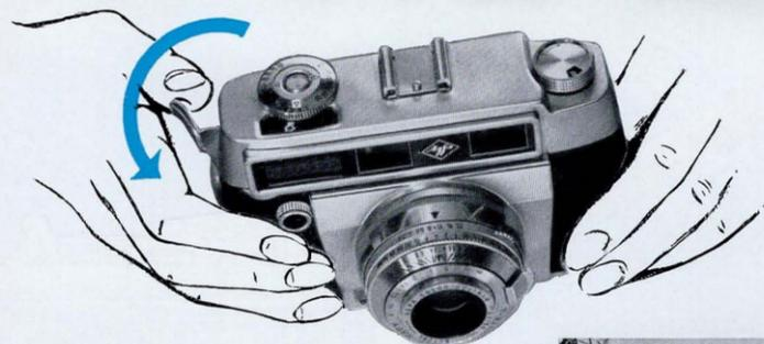
Der doppelköpfige Schwan demonstriert Ihnen, wie der mit dem Objektiv gekuppelte Entfernungsmesser arbeitet. Doppelt sehen Sie das Motiv im Sucher bevor Sie scharf eingestellt haben. Dann drehen Sie am Entfernungsring ① bis sich Meß- und Sucherbild decken, und schon ist das Objektiv automatisch auf die richtige Entfernung eingestellt.
