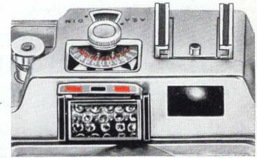
Bei schwachem Licht öffnen Sie die Blendklappe. Damit schaltet sich automatisch der zweite Meßbereich ein, und nun sind die roten Zahlen der Skala gültig.
