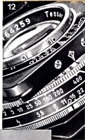
**Zweipunkteinstellung (Abb. 12).** Bei einer bestimmten Entfernungs- und Blendeneinstellung reicht der Schärfenbereich von Unendlich bis etwa 4 m, umfaßt also den ganzen Raum, der für die Mehrzahl der üblichen Aufnahmen in Frage kommt. Diese beiden Einstellungen sind bei den Zeiss Ikon Rollfilmcameras mit je einem roten Punkt gekennzeichnet. Für Schnappschüsse ist dies die gegebene Einstellung.
