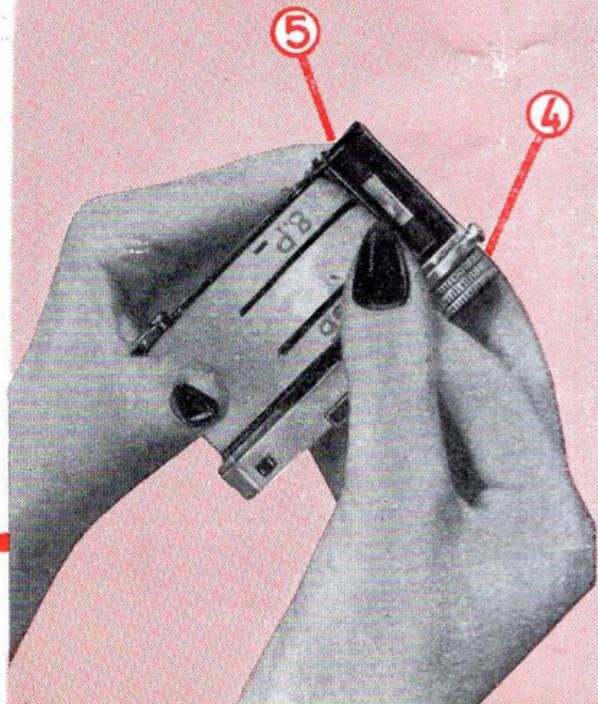
Le dos étant retiré, vous voyez deux logements de bobines : l'un correspondant au **bouton d'enroulement (4)** qui entraîne un axe vide sur lequel s'enroulera, au fur et à mesure des prises de vues, la pellicule exposée; l'autre reçoit la pellicule vierge à utiliser.
