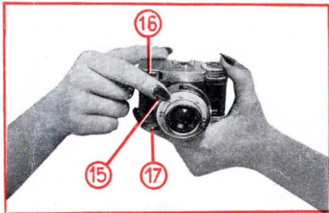
Les axes optique et de visée étant très rapprochés, l'erreur due à la parallaxe est négligeable.
