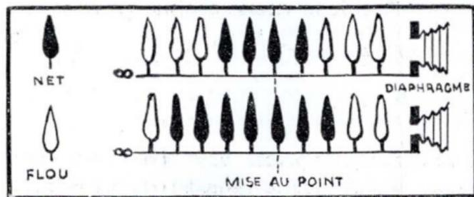
Par exemple : si la distance est réglée sur 3 m et le diaphragme sur 8, tous les sujets placés entre 2,10 et 6 m seront nets (premier plan net dans une photo de paysage, par exemple).
