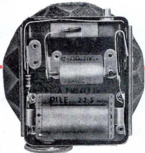
C'est un dispositif pratique fonctionnant avec un condensateur alimenté par une pile de 22,5 V ou, sans condensateur, avec une pile ordinaire de 4,5 V. Ce flash utilise les lampes flash type 1 ou 14.
