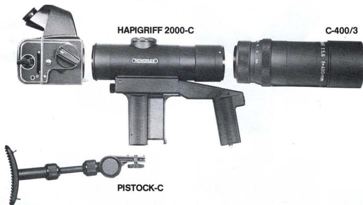
Der 3linsige 400 mm Objektivkopf zeichnet das 6 x 6-Format voll aus. Der Einstellbereich geht von unendlich bis 6,5 m. Das Bildfeld bei nächster Einstellung beträgt 80 x 80 cm bei 6 x 6 oder 60 x 80 cm bei 4,5 x 6, Gewicht 2130 g. Der 400/3 mm Objektivkopf ist der gleiche wie beim Schnellschuß-Objektiv für das Kleinbildformat. Dies bedeutet für den Besitzer einer KB-Spiegelreflex-Kamera und einer 4,5 x 6- bzw. 6 x 6-Kamera, daß er nur einen Objektivkopf 400/3 mm benötigt.
