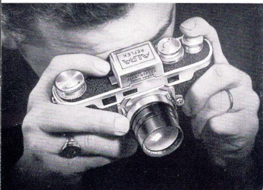
1 El telémetro va acoplado con los objetivos de foco normal (5 cm.). El enfoque se realiza automáticamente desde 1 m. hasta el infinito.
