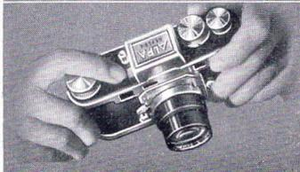
Al efectuarse el disparo, el espejo inoxidable se levanta automáticamente — se verifica la exposición de la película — el espejo vuelve a caer a su posición inicial y la imagen reaparece en el visor.
